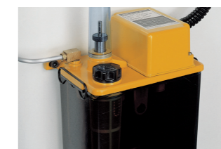
Автоматическая система смазки направляющих
