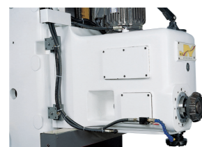
Пневматическая система зажима координат по осям Y и Z
