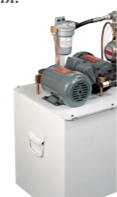
Система маслянного охлаждения шпинделя
